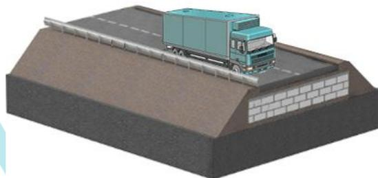
На 1 укладку одной насыпи дороги требуется- **~30 тыс. м<sup>3</sup> пенополистирольных блоков**
