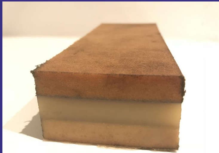
Трёхслойный полиуретановый элемент. Наружный слой - вспененный полиуретан, плотность 670 г/дм.куб. Внутренний слой - полиуретан, плотность 1220 г/дм.куб.
