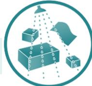
С добавлением специальных чистящих растворов «дробленка» очищается от пыли и других неполиэтиленовых включений.
