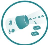
Расплав полимера продавливается через фильтр во вращающуюся голову экструдера. Из него выходят нити. Для охлаждения они пускаются по водяному рукаву, а затем – в ножи, где режутся на однородные гранулы.
