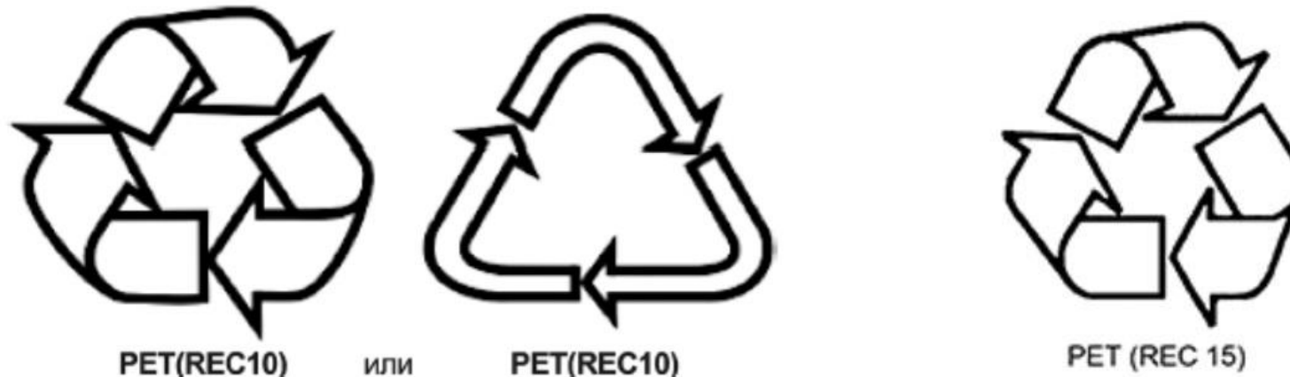
Рисунок В.2 Маркировка упаковки из материала, изготовленного из смеси первичного полимерного материала с добавлением рециклированного полимерного материала
