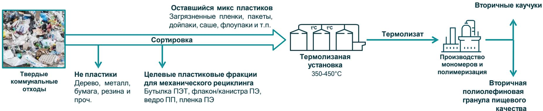
Технология химического рециклинга (Термолиза) позволяет полностью решить вопрос переработки пластиковых отходов и получать вторичные полимеры для использования в пищевом сегменте
