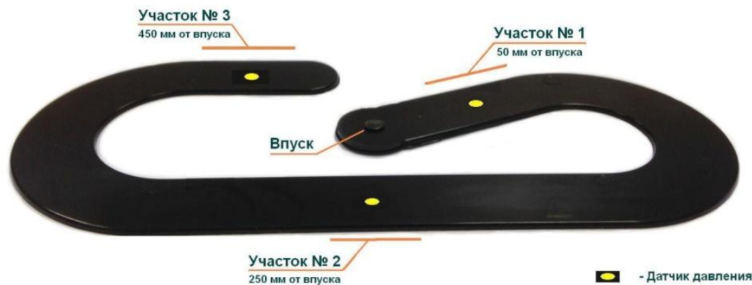
Образец «спираль» 500×25×2 мм
