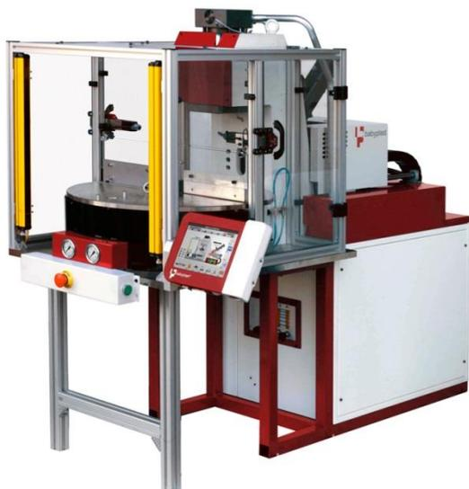
Помимо передвижного стола предусмотрена возможность поставки термопластавтомата, укомплектованного поворотным столом. С помощью поворотного стола диаметром 600 мм может осуществляться автоматический поворот обеих нижних частей формы на 180° за 2 с. Этот вариант исполнения машины предназначен для работы как в полуавтоматическом режиме с участием человека, так и в автоматическом режиме с использованием роботоманипуляторов, производящих закладку арматуры и съем готовой продукции и литников.
