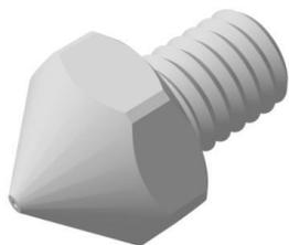
**ЗАДАЧА:** изготовить сопло из Al<sub>2</sub>O<sub>3</sub> согласно 3D-модели.
