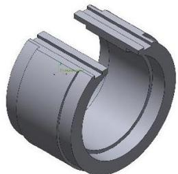
**Задача:** изготовить коллекторную втулку из Al<sub>2</sub>O<sub>3</sub> согласно 3D-модели и техническим требованиям. Данная втулка применяется в электронно-компонентной базе для космических аппаратов.
