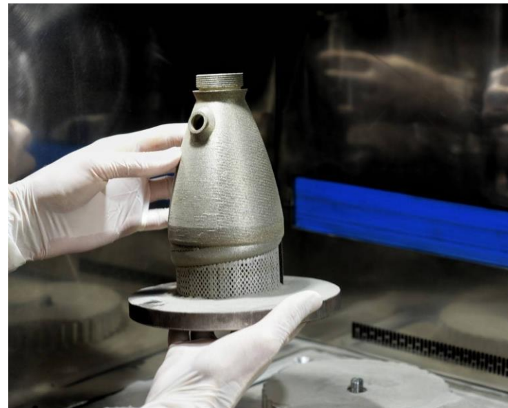
Циклонный фильтр (фото компании 3DLAM). Материал ПР-03Х17Н12М2 (аналог 316L) производства АО «ПОЛЕМА»
