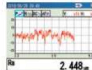
Пример измерения шероховатости поверхности (Ra)
