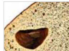
Изображение с воксельным разрешением 19 мкм используется для просмотра характеристик и пористости
